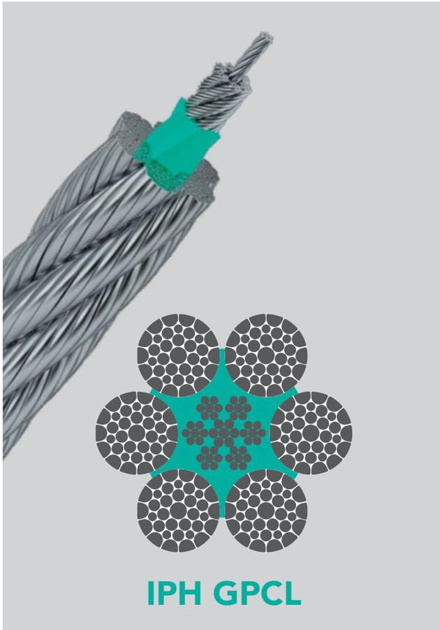
Cable de 6 cordones compactados con alma plastificada, recomendado para izaje y arrastre en dragalina y también como cable de volcado. Extra alta resistencia por el compactado de los cordones y el aporte del recubrimiento plástico sobre el alma de acero.
